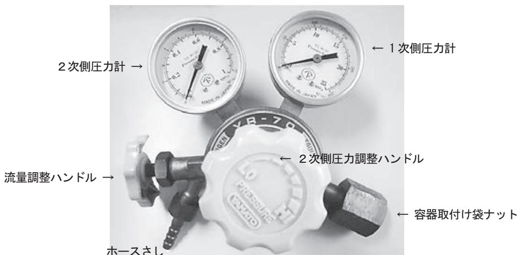
図7-4 圧力調整器
