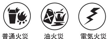
実験室で起きる小規模火災には、消火後の消火剤による被害を考えて、二酸化炭素消火器→粉末消火器→泡消火器の順に用いるのがよい。工学部の施設内にはA、B、Cのどの火災にも対応できる粉末消火器が常備されている。
